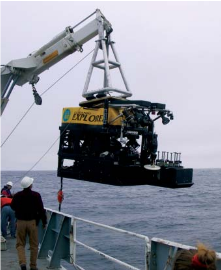
Des submersibles commandés à distance permettent aux scientifiques de contrôler l'échantillonnage dans des zones inaccessibles (West Coast NURP)
