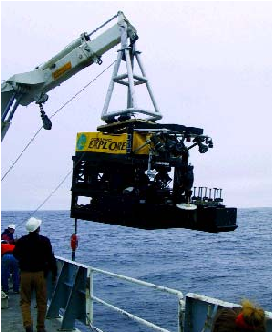
遥控作业潜水器可以使科学家在人无法到达的海底控制取样过程 (West Coast NURP)
